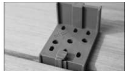
Gewünschten Fugenabstand mit Adapter (+1 mm) ändern
